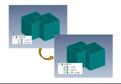
「ブーリアン EX」は、[ジオメトリ]-[ソリッド]コマンドの[和]、[差]、[積]、[埋込み]の処理を、元のジオメトリを消さずに行うツールです。
