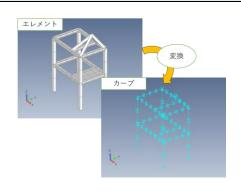
「線要素からカーブ作成」は、線要素の端点の座標を元にカーブを作成するツールです。また、線要素に設定されていたプロパティを、作成したカーブに割り当てることもできます。
