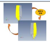
「選択 API」は、Femap のエンティティ選択ダイアログから呼び出して使用する、通常のエンティティ選択ダイアログではできない、新しい「エンティティ選択方法」が使用できるツールです。
